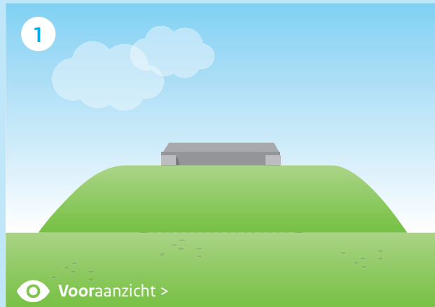
1 Vooraanzicht > De kazematten hadden in de oude situatie een gronddekking zodat ze niet zichtbaar waren voor de vijand.
